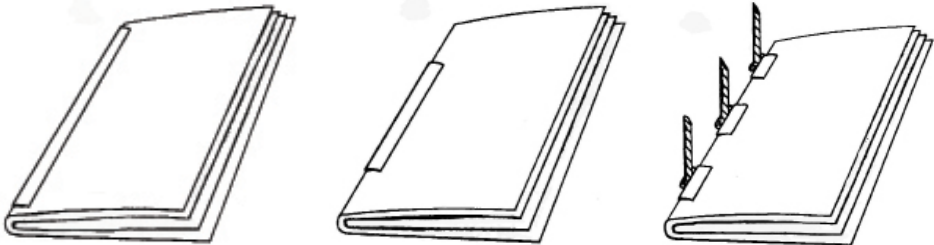
Figura 4 Tecniche di rinforzo alla piega dei fascicoli. Il materiale usato copre tutta la lunghezza del fascicolo (1), copre parte della lunghezza (2), solo in corrispondenza dei supporti di cucitura (3)
