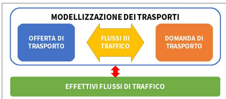
Figura 1 Le componenti di un sistema di trasporti secondo uno schema di modellizzazione consolidato
