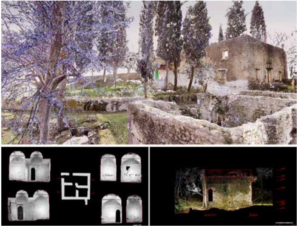
Figura 5. Attività di rilevamento a Xhermahalle, Albania. Nuvola di punti del complesso e proiezioni ortografiche del piccolo hāmām (fonte: Versaci, Cardaci 2015)
